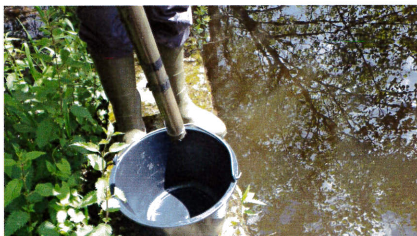
Photo 6 : Prélèvement de sédiments par carottage au tube (zoom)
